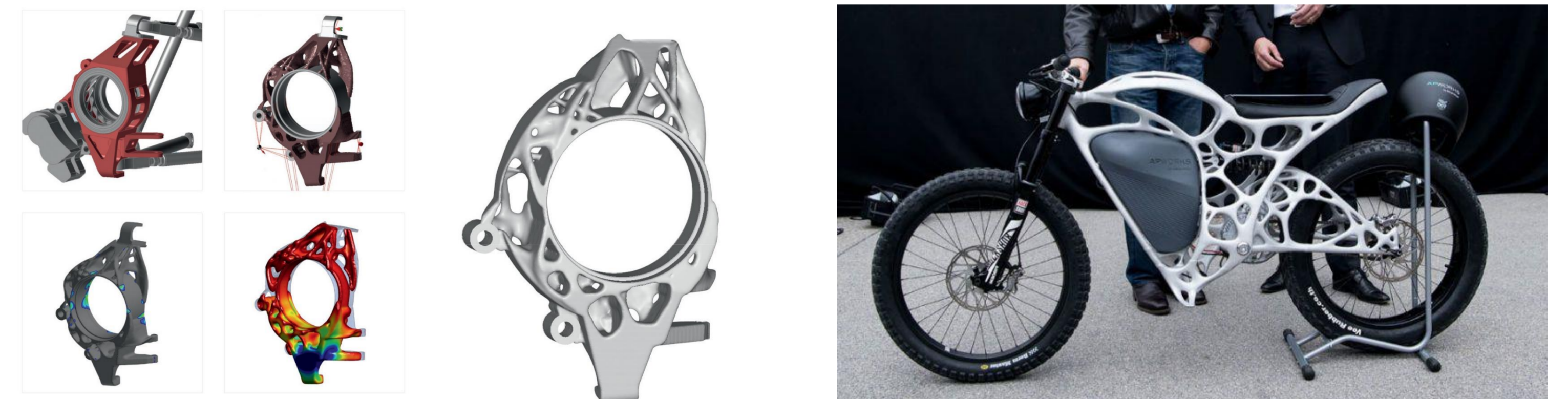
1- שלדת אופנוע בסיום תהליך האופטימיזציה 2- תהליך האופטימיזציה על בית גלגל
